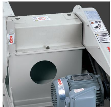
ベルトカバー (材質 / FRP)：屋外防雨型の裏側折り込み式半密閉タイプ。安全のために裏側からも手や指が入らないように設計されています。但し、下部のみ開放。ベルトの張り具合の点検はここから容易にできます。
